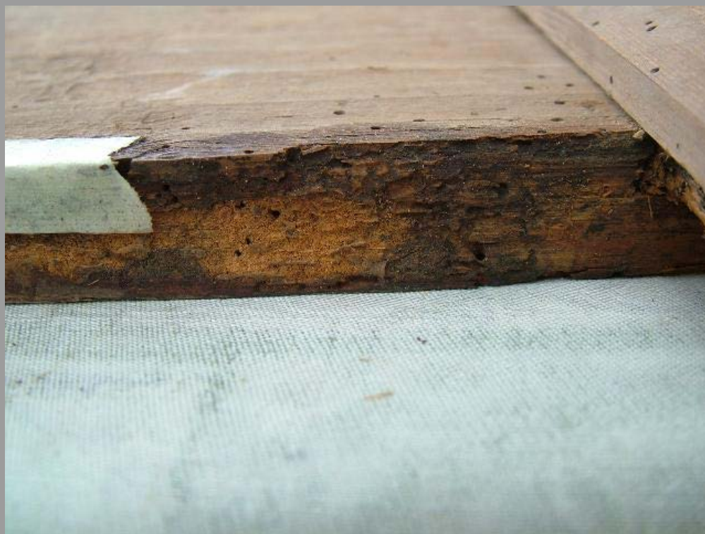
9. fotó. Rovarkárosodások nyomai
